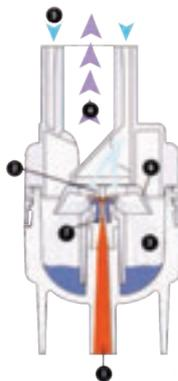
**Principe de fonctionnement du « Sidestream »**
